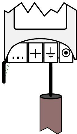
Las sondas de medida de este dispositivo son del tipo DS18B20, su alimentación es de 3,3V y se comunican con el equipo a través de un único cable. En el bornero auxiliar tenemos tanto las bornas de alimentación, gnd y positivo, como la borna de comunicaciones con la sonda.
